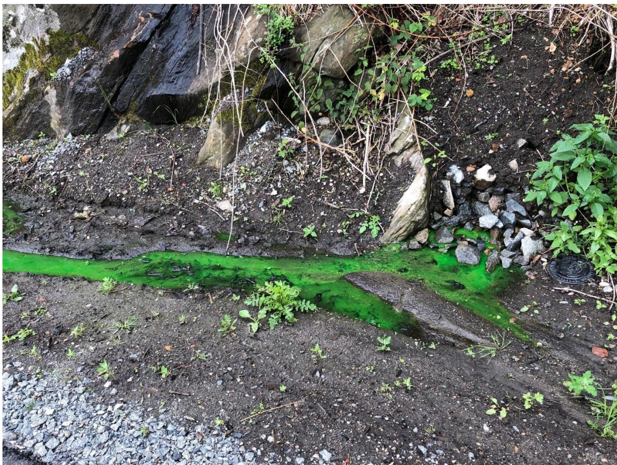
Figur 13 Eksempel fra en fargetest for å avdekke feilkoblinger, foto: Elisabeth Bokheim
